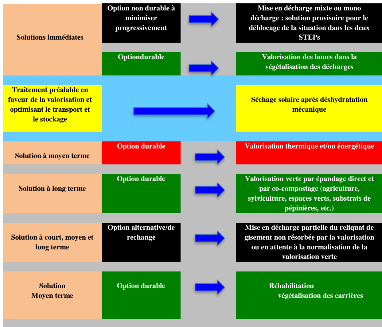
Figure 11. Options envisageables pour l'élimination et la valorisation des boues des STEPs d'Al Hoceima et de Nador
